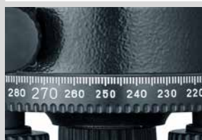
Círculo horizontal con mecanismo de ajuste de precisión lateral infinito para apuntar con exactitud.
