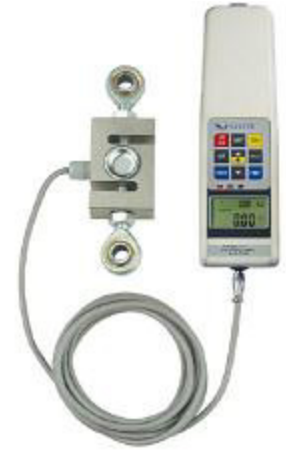
Célula de carga externa a partir de 1.000 Newton de capacidad.
