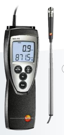
El testo 416 es un anemómetro compacto provisto de una sonda de molinete de 16 mm de diámetro conectada por cable fijo. La empuñadura telescópica de la sonda se extiende hasta los 890 mm, por lo que este instrumento es ideal para medir la velocidad en conductos.
