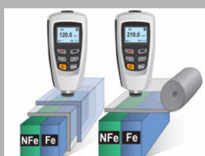
Medición del espesor de capas y del grosor de láminas
