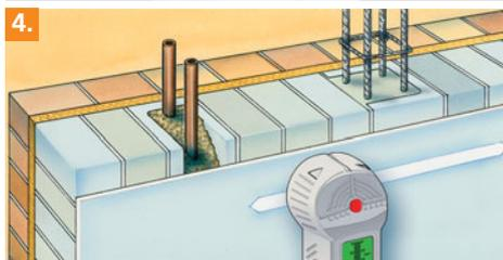
Permite detectar directamente metales: hierros de construcción, tubos de calefacción y tuberías de agua. Interfaz de usuario con una gran pantalla LCD.
