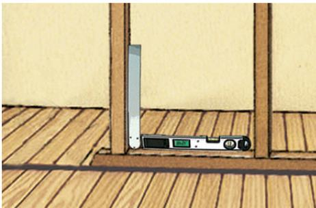
**1. Permite determinar con precisión el ángulo interior y exterior de 0-220°:** para medir la inclinación del tejado y ajustar muebles o ventanas a las esquinas y los cantos.
