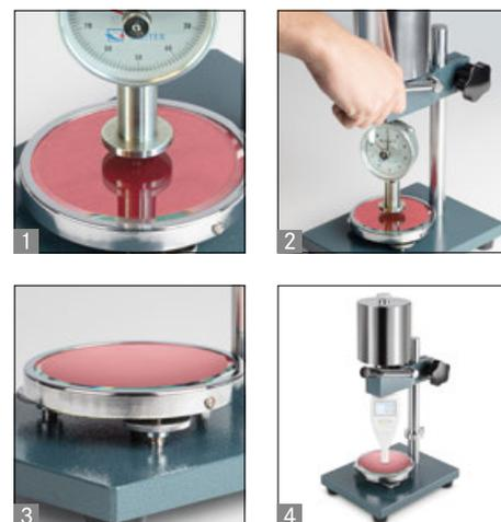
Banco de pruebas con palanca para pruebas de dureza reproducibles con placa base de cristal
