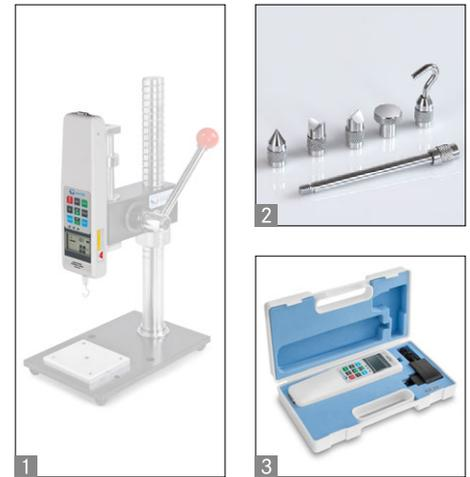
Medidor digital universal de fuerza para mediciones de fuerza en tracción y en compresión con célula de carga integrada
