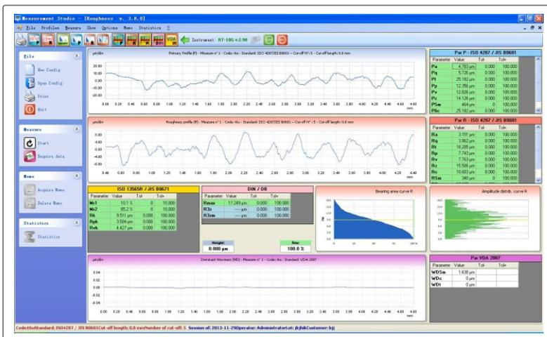
software de medición (opcional), muestra los datos de la rugosidad de la pieza
