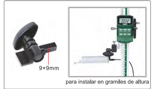
**NOTA:** Por favor, confirme si el adaptador es el adecuado para su gramil de altura. Cuando utilice gramiles de la marca INSIZE, por favor, utilice el adaptador
