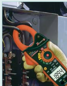
Medidor RMS real le suministra lecturas precisas de formas de onda no sinusoidal.
